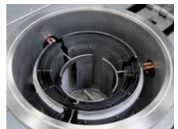
带钨丝加热装置的圆柱形气密罐
