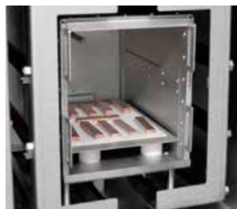
在氢气环境下，在 VHT 8/16-MO型罐式炉内对铜棒进行热处理
