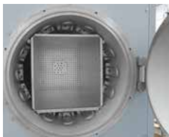
NRA ../06型罐式炉设有内置加热元件
