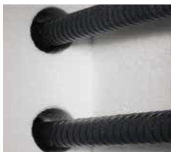
炉膛采用优质纤维材料，SiC加热棒位于炉两侧
