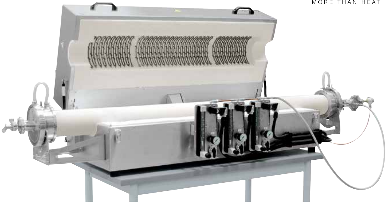
RS 120/1000/13S型管式炉，带气密管、安装在一个纤维模块中的加热元件、炉料控制装置和出气口上的止回阀
