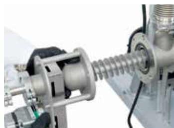
转速可调节式螺旋输送机
